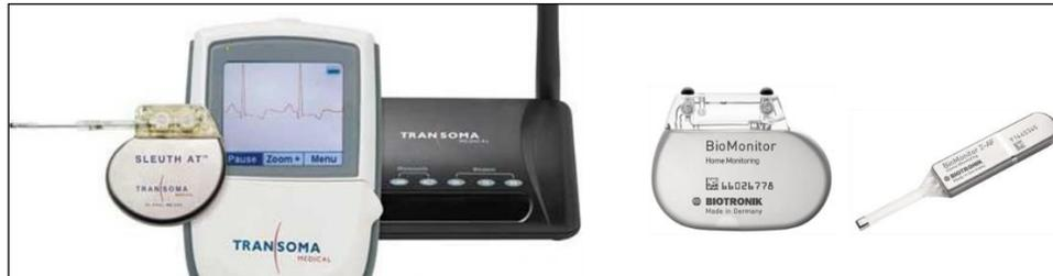
Figure 07-04 : dispositif ILR de haute définition avec dispositif personnel d'enregistrement wireless permettant une transmission rapide des données « alertes ou non » vers un centre de contrôle ; puis au cardiologue traitant. Ce dispositif ressemble au Biomonitor-1 de Biotronik ... actuellement remplacé par le Biomonitor-2 plus petit.
