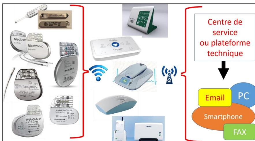
Figure 07-08 : possibilité de télécardiologie via les devices, le système wireless jusqu'aux consoles des différentes firmes, permettant l'envoi des données via le net jusqu'à un centre de service, et par la suite, jusqu'au médecin.
